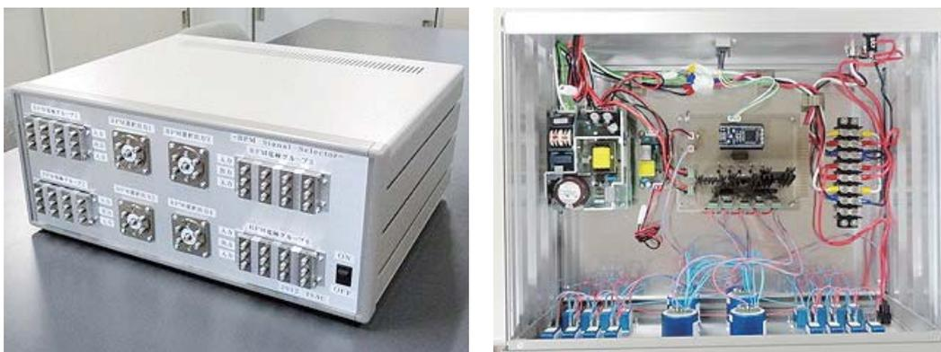
図4 電極切替機外観 (左) 電極切替機内部 (右)
