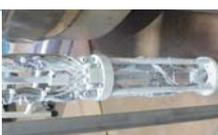
核融合科学研究所からの施設利用により高性能超電導線材開発のための臨界電流特性測定用プローブの開発を行っています。ボア径52 mm内で動作可能な引張・曲げ動作機構の設計を行っています。(近藤、杉戸、青山)
