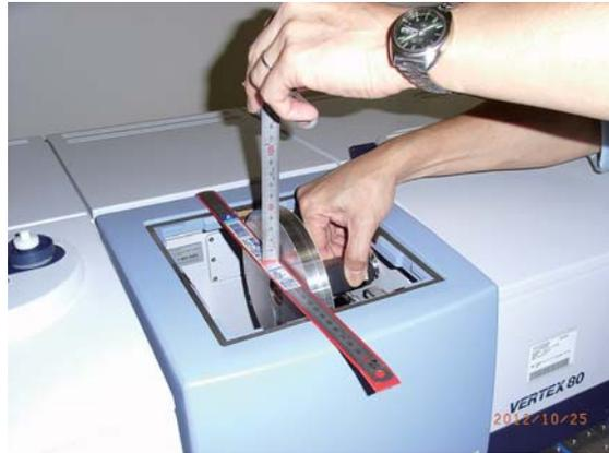
図5 試料カバーの突出し量確認
