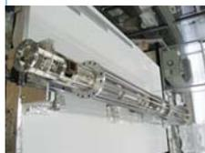
神戸大学からの製作依頼で、以前、施設利用により製作協力した当装置の改良に協力しています。主にRF(Radio Frequency)コイルやNMRセル支持フランジおよびドリフトチューブなどの製作や技術相談に対応しています。(矢野、青山)
