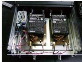
製作したパルス電源は、パルスの立ち上がり時間：約10 nS、振幅：最大6 KV、パルス幅：最小約6 uS、繰り返し：最大約100 kHzのパルス出力を得ています。
