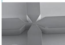
生体分子情報研究部門からの製作依頼により、2液混合によるタンパク質の構造変化を、蛍光強度の変化から予想するために使用されるマイクロ流路ミキサーを、フォトソングラフィーにより製作しています。(高田)
