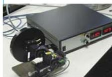
生体分子情報研究部門からの製作依頼により、光エネルギー変換系における水分子の関わりを時間分解偏光赤外分光法で解明するための試料駆動装置の製作を行いました。(水谷、内山)
