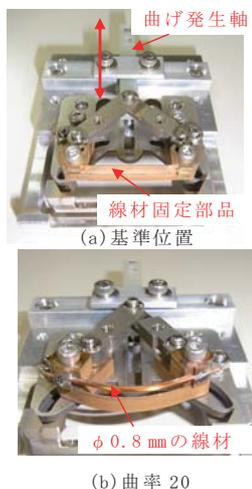
図1 試作した曲げ印加機構
