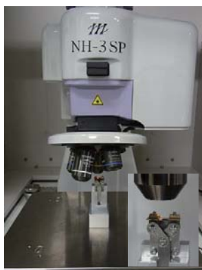
図5 たわみ量測定の様子
