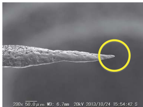
図3 試作したCr探針 Ver.2
