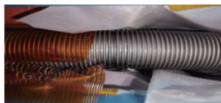
真空リークを起こしたベローズ偏向ダクト
