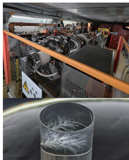
図3 上: 実習で運転した、教育加速器KETA 下: 運転実習の“成果物”美しいリヒテンベルク図形が現れる
