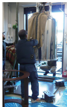
写真2 マグネットの搬出 (専用治具を組み立ててマグネットを吊り下げて扉付近まで移動させた後、クレーン車へ積み込み)
